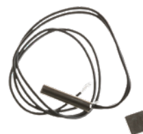
Türsensor und Magnet
